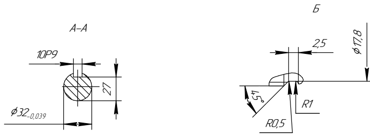
Рисунок Б.8 (обязательное) Габаритные, установочные и присоединительные размеры двигателей АИМУ основного исполнения. (с удлиненным валом АИМУ 180)
